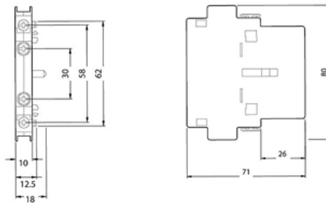
Рис.3 Габаритные размеры 3RH1921-1EA
